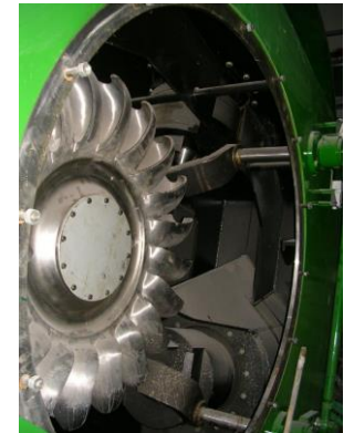
Turbina Pelton (2 getti)
